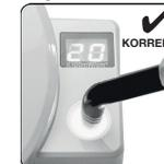
Lichtspitze ist flach gehalten und passt genau auf den Lichtsensor. Lichtintensitätsanzeige zeigt korrekte Bestrahlungsstärke an.
