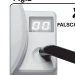
Lichtspitze ist nicht flach gegen den Lichtsensor gehalten. Lichtintensitätsanzeige zeigt fehlerhafte Bestrahlungsstärke an.
